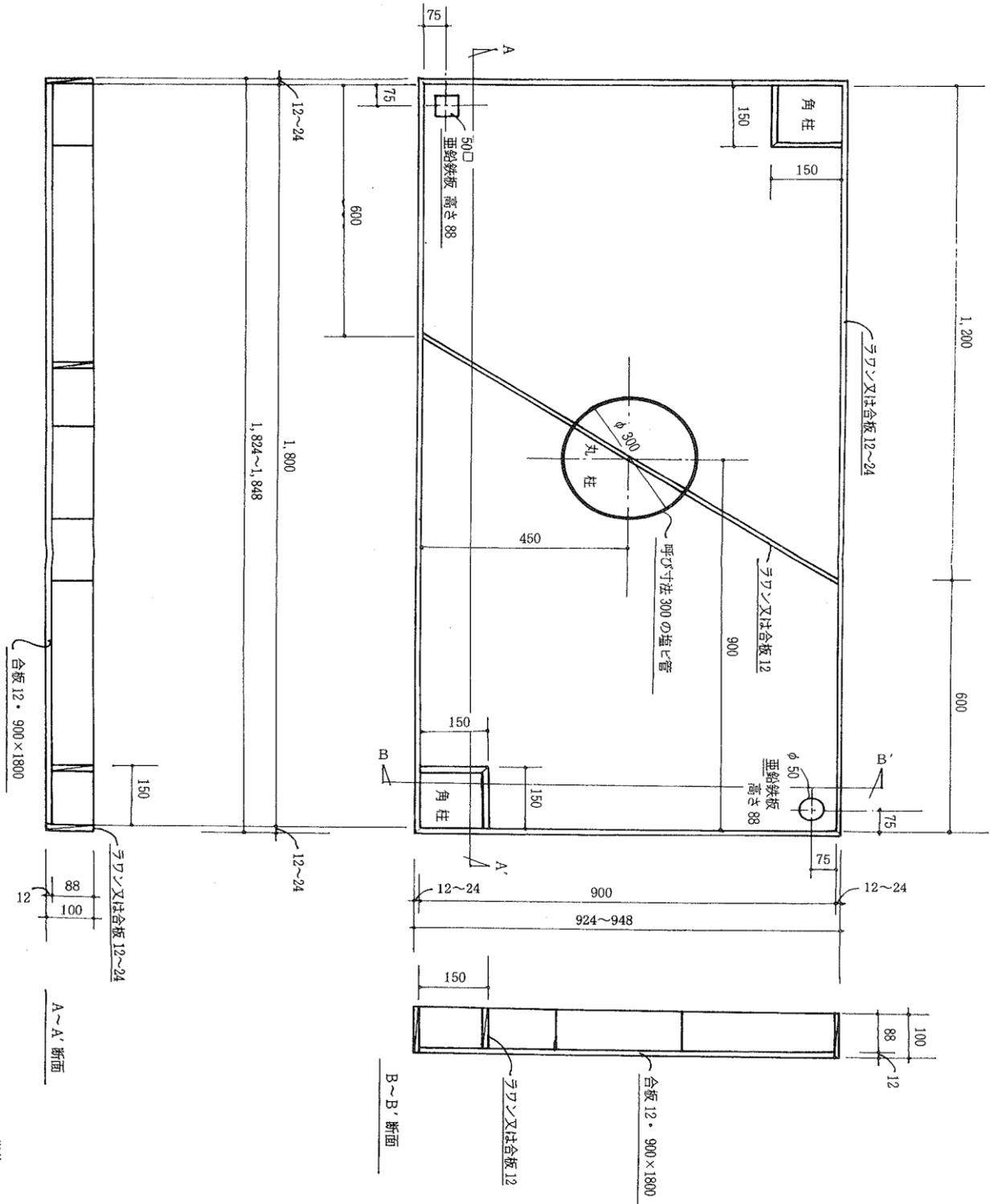
注) 試験台を継続使用する場合には、平床場に2.7mm厚の合板を打ち付けて使用すること。
